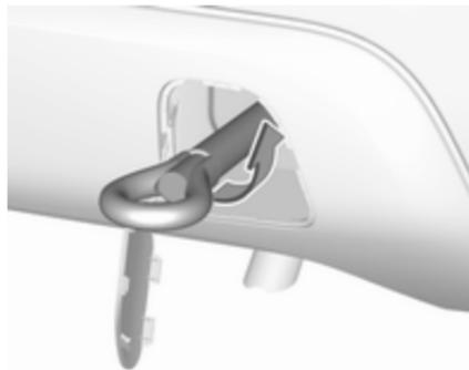
Abschleppöse bis zum Anschlag in waagrecht Stellung einschrauben.
