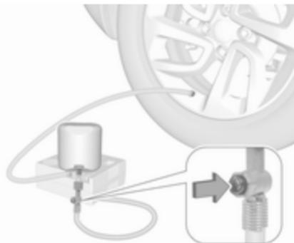
Zu hohen Reifendruck mithilfe der Taste am Luftschlauch korrigieren.
