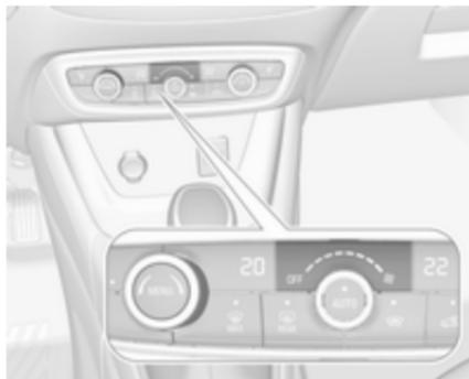
Luftstrom durch Drehen des Drehknopfs ☼ auf die gewünschte Geschwindigkeit einstellen. Zum Senken nach links, zum Erhöhen nach rechts drehen. Die Gebläsezahl kann auch über Schaltflächen im Display der Klimatisierungseinstellungen geändert werden. Zum Öffnen des Menüs auf **MENU** drücken.
