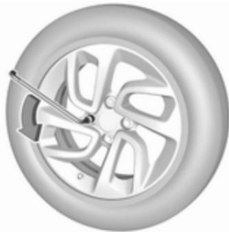
2. Radschraubenschlüssel ausklappen und so ansetzen, dass er gut sitzt. Die Radschrauben jeweils eine halbe Umdrehung lösen.
