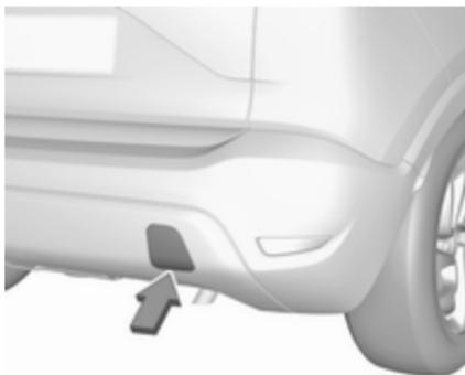
Die Spitze eines Schlitzschraubendrehers mit einem Tuch umwickeln, um den Lack zu schützen. Einen Schraubendreher in den unten an der Abdeckung befindlichen Schlitz einsetzen. Abdeckung durch vorsichtiges Abwärtsbewegen des Schraubendrehers lösen.
