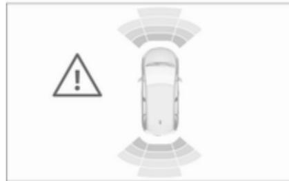
Außerdem wird die Entfernung zu Hindernissen hinter bzw. vor dem Fahrzeug durch veränderliche Abstandslinien im Info-Display ↻ 102 angezeigt.
