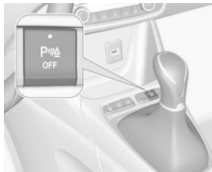
Beim Ausrücken des Rückwärtsgangs wird das System ausgeschaltet. Um das System manuell zu deaktivieren, **P+OFF** drücken. Bei deaktiviertem System leuchtet die LED in der Taste. Wenn das System manuell deaktiviert
