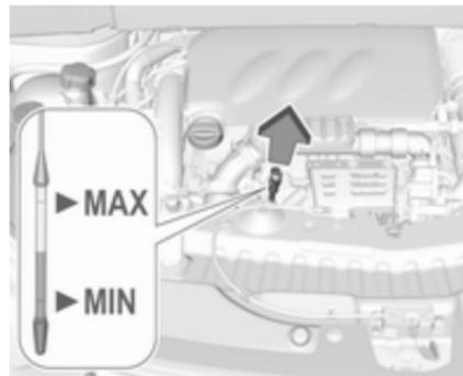
Den Messstab herausziehen, sauber wischen, vollständig einsetzen, herausziehen und den Motorölstand ablesen.
