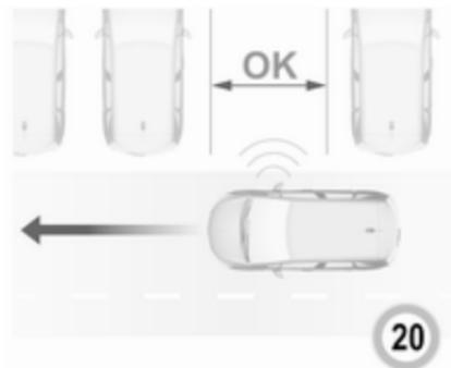
Wenn eine freie Parklücke erkannt wird, erscheint eine entsprechende Abbildung im Colour-Info-Display und ein Signalton ertönt. Das Fahrzeug anhalten, den Rückwärtsgang einlegen, das Lenkrad loslassen und mit maximal 7 km/h fahren.
