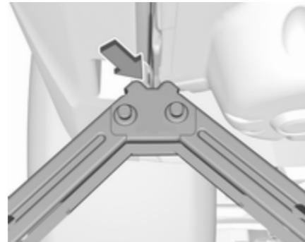
Sicherstellen, dass die Karosseriekante in die Kerbe am Wagenheber passt.
