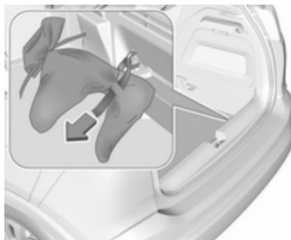
Den Gurt durch die hintere rechte Verzurröse führen, zweimal um den Beutel schlagen und zum Sichern des Beutels spannen.
