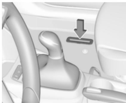
Die Fahrzeug-Identifizierungsnummer kann in das Typschild und die Bodenwanne (unter der Bodenabdeckung, sichtbar unter einer Abdeckung) eingestanzt sein.
