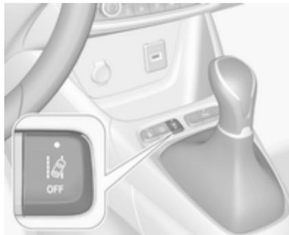
Die Spurverlassenswarnung wird durch Drücken von
