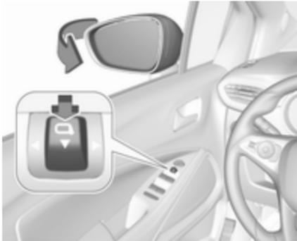
Die Spiegeltaste nach hinten schieben. Beide Außenspiegel werden eingeklappt.
