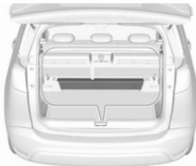
Das Warndreieck im Fach an der Rückseite des Laderaums verstauen und mit dem Klettband sichern.
