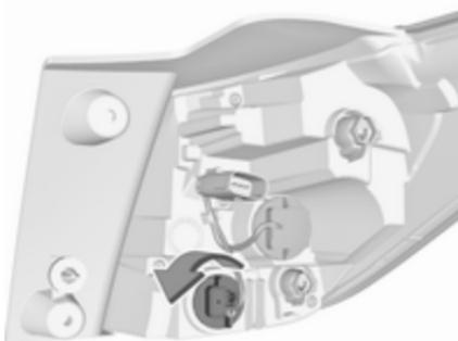
Die Lampenfassung linksherum aus dem Gehäuse herausdrehen.
