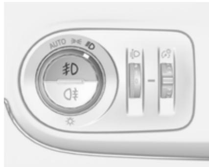
Wird durch Drücken von  $\text{☞D}$  bedient.
