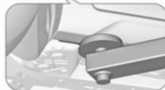
Vordere Arme der Hebebühne befinden sich mittig unter den entsprechenden Wagenheberaufnahmen.
