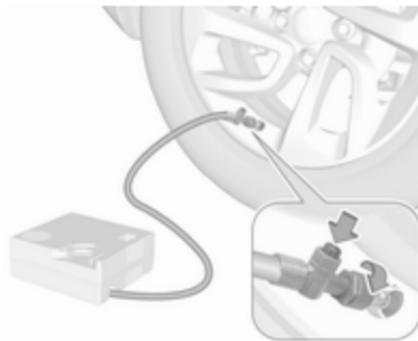
16. Fahrt unverzüglich fortsetzen, damit sich das Dichtmittel im Reifen gleichmäßig verteilt. Nach ca. 5 km Fahrtstrecke (spätestens jedoch nach 10 min) anhalten und den Reifendruck kontrollieren. Hierzu den Luftschlauch des Kompressors direkt auf das Reifenventil schrauben. Den Reifen wie zuvor beschrieben mit Luft befüllen. Zu hohen Reifendruck mithilfe der Taste am Luftschlauch korrigieren.
