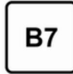
Diesekraftstoff gemäß der Norm EN590, mit Beimischung eines Biokraftstoffs gemäß der Norm EN14214 (der bis zu 7 % Fettsäuremethylester enthalten darf).
