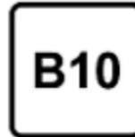
Diesekraftstoff gemäß der Norm EN16734, mit Beimischung eines Biokraftstoffs gemäß der Norm EN14214 (der bis zu 10 % Fettsäuremethylester enthalten darf).
