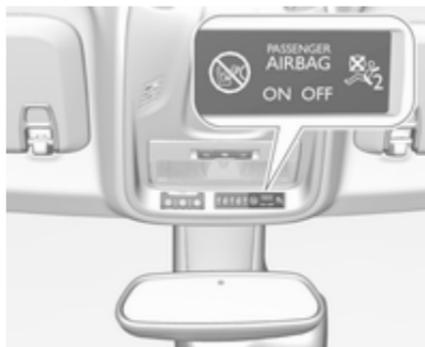
Wenn die Kontrollleuchte ☹ON nach dem Einschalten der Zündung ca. 60 Sekunden lang leuchtet, löst der Beifahrer-Airbag bei einem Unfall aus.
