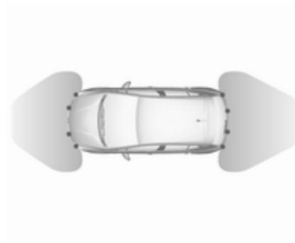
Das System arbeitet mit je vier Ultraschall-Parksensoren im hinteren und vorderen Stoßfänger.
