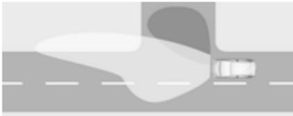
Je nach Lenkwinkel und Blinklicht werden beim Abbiegen spezielle LEDs eingeschaltet, um die Fahrtrichtung auszuleuchten. Er wird bei Geschwindigkeiten von bis zu 40 km/h aktiviert.
