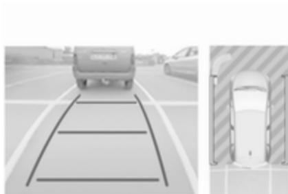
Im linken Displaybereich können verschiedene Ansichten ausgewählt werden. Die Ansicht kann während eines Manövers jederzeit geändert werden, indem das Feld unten links im Display angetippt wird:
