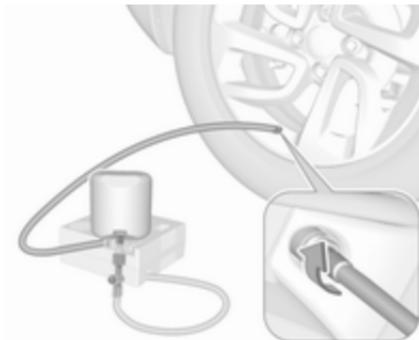
7. Einfüllschlauch an Reifenventil anschrauben.
