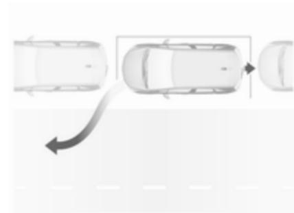
Vor- und zurücksetzen und dabei die Warnungen der Einparkhilfe beachten, bis der Abschluss des Manövers angezeigt wird. Das Manöver ist abgeschlossen, sobald die Vorderäder des Fahrzeugs die Parklücke verlassen haben.  $\text{P}_S$  im Instrument erlischt.
