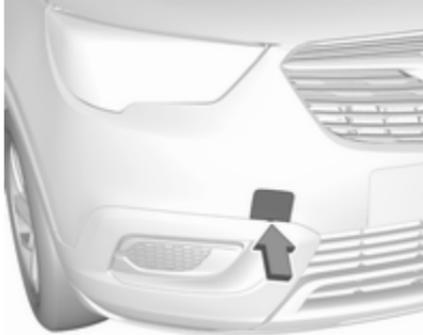
Die Spitze eines Schlitzschraubendrehers mit einem Tuch umwickeln, um den Lack zu schützen. Einen Schraubendreher in den unten an der Abdeckung befindlichen Schlitz einsetzen. Abdeckung durch vorsichtiges Abwärtsbewegen des Schraubendrehers lösen.
