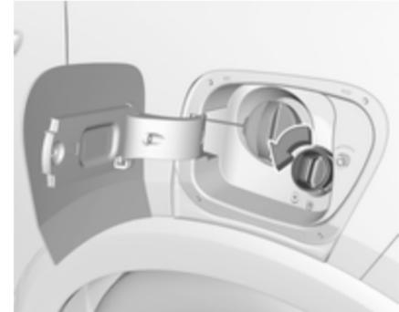
4. Die Schutzkappe vom Einfüllstutzen abschrauben.
