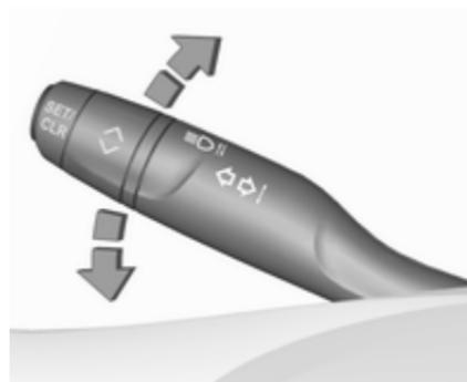
Hebel nach oben : Blinker rechts
