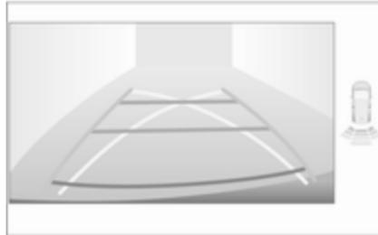
Die senkrechten Linien zeigen die Ausrichtung des Fahrzeugs. Der Abstand zwischen den senkrechten Linien entspricht der Breite des Fahrzeugs ohne Außenspiegel. Die erste waagerechte Linie markiert eine Entfernung von ca. 30 cm zum Rand des Heckstoßfängers. Die oberen waagerechten Linien entsprechen einer Entfernung von ca. 1 und 2 m hinter dem Rand des Heckstoßfängers. Die sich kreuzenden Bogen stellen den maximalen Wendekreis dar.
