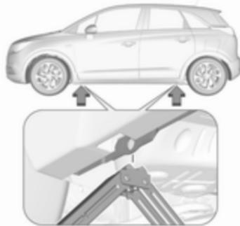
3. Sicherstellen, dass der Wagenheber richtig unter dem entsprechenden Ansatzpunkt ausgerichtet ist.
