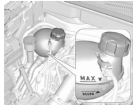
Bei kaltem Kühlsystem sollte der Kühlmittelstand über der **MIN**-Markierung liegen. Bei zu niedrigem Füllstand auffüllen.
