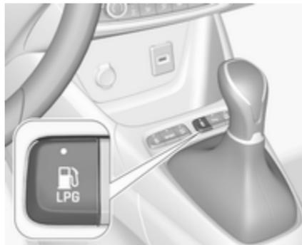
Durch Drücken von **LPG** wird zwischen Benzin- und Flüssiggasbetrieb umgeschaltet, sobald die erforderlichen Parameter (Kühlmitteltemperatur, Gastemperatur und Minstdrehzahl des Motors) erreicht sind. Die Anforderungen sind normalerweise nach etwa 60 Sekunden (je nach Außentemperatur) und der ersten festen Betätigung des Gaspedals erreicht. Der LED-Status zeigt bei laufendem Motor den aktuellen Betriebsmodus.
