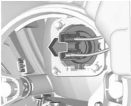
2. Die obere Lampenfassung aus dem Reflektorgehäuse ziehen.
