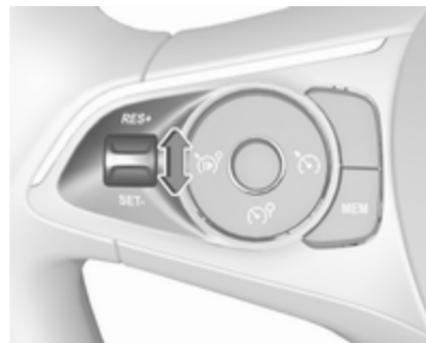
Auf die gewünschte Geschwindigkeit beschleunigen und das Daumenrädchen kurz auf **SET/-** schieben. Die aktuelle Geschwindigkeit wird gespeichert und konstant gehalten. Gaspedal kann gelöst werden.
