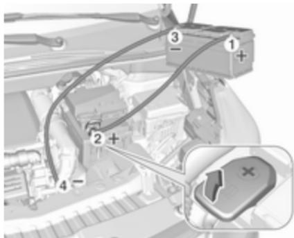
Die Pluspolenschutzkappen an beiden Fahrzeugbatterien öffnen.
