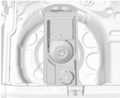
Der Schraubendreher und die Abschleppöse befinden sich in einem Kasten unter der Bodenabdeckung im Laderaum.
