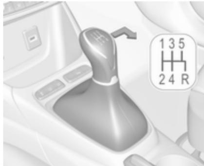
Zum Einlegen des Rückwärtsgangs beim 5-Gang-Getriebe das Kupplungspedal betätigen und dann den Wählhebel nach rechts und nach hinten bewegen.
