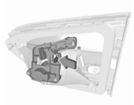
4. Die Lampenfassung durch Drücken auf die Haltenase lösen und dann herausnehmen.
