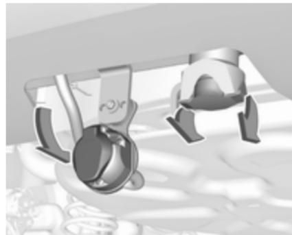
Die Steckdose nach unten schwenken. Verschlussstopfen von der Öffnung für die Kugelstange entfernen und verstauen.
