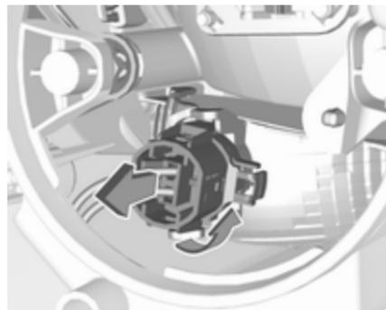
2. Die untere Lampenfassung links herum herausdrehen. Die Lampenfassung aus dem Reflektorgehäuse ziehen.
