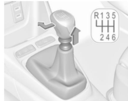
Zum Einlegen des Rückwärtsgangs beim 6-Gang-Getriebe das Kupplungspedal betätigen, den Ring unter dem Wählhebel nach oben ziehen und den Wählhebel nach links und nach vorne bewegen.
