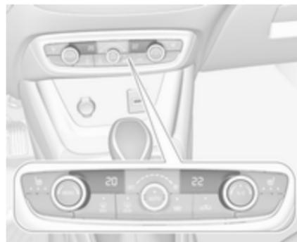
Gewünschte Temperaturvoreinstellungen für Fahrer und Beifahrer separat über linken und rechten Drehregler festlegen. Über den Drehregler auf der Beifahrerseite lässt sich die Temperatur für die Beifahrerseite ändern. Mit dem Drehregler auf der Fahrerseite wird je nach Aktivierung der Synchronisierung **MONO** im Menü der Klimatisierungseinstellungen die Temperatur entweder nur für die Fahrerseite oder für beide Seiten geändert. Zum Öffnen des Menüs auf **MENU** drücken.
