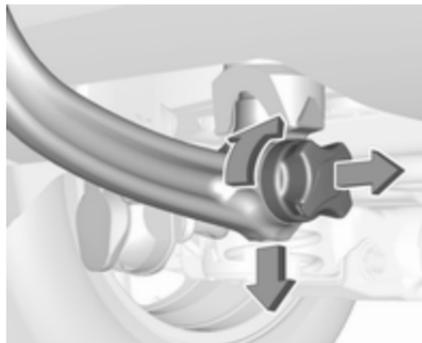
Die Schutzklappe öffnen und zum Entriegeln der Kugelstange den Schlüssel in Position
