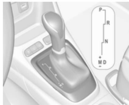
Zum Schalten den Wählhebel wie oben abgebildet durch die Schaltkullisse führen.
