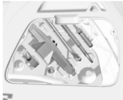
Der Wagenheber, das Wagenwerkzeug, der Gurt zur Befestigung des defekten Rads und die Abschleppöse befinden sich im Werkzeugkasten, der in der rechten Seitenwand des Laderaums untergebracht ist.
