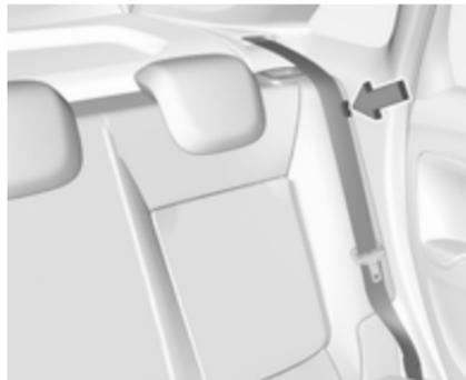
Beim Umklappen der Rückenlehnen die Sicherheitsgurte in die Führungslaschen einführen und mit der Umklappbewegung herausziehen.
