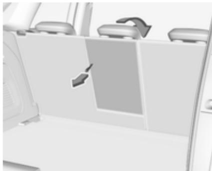
Die Armlehne kann auch von hinten durch Ziehen an der Schlaufe umgeklappt werden.
