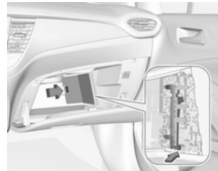
Bei Linkslenkern befindet sich der Sicherungskasten hinter einer Abdeckung im Handschuhfach. Handschuhfach öffnen und Abdeckung entfernen. Den Halter entfernen.
