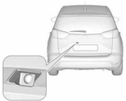
Die Kamera ist über dem Kennzeichenschild montiert.
