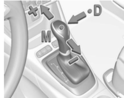
Schieben Sie den Wählhebel aus **D** nach links auf **M**.
