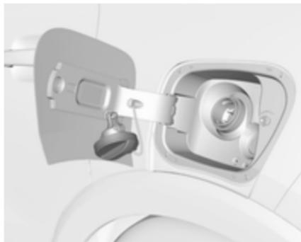
Der Tankdeckel kann am Haken an der Tankklappe eingehängt werden. Die Tankdüse gerade am Einfüllstutzen ansetzen und mit geringem Kraftaufwand einstecken.
