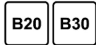
Die Dieselmotoren können mit dem Kraftstoff B20 oder B30 gemäß der Norm EN16709 betrieben werden. Bei dessen – auch gelegentlicher – Verwendung müssen jedoch die speziellen Wartungsbedingungen für „schwierige Bedingungen“ genau eingehalten werden.
