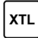
Paraffin-Diesekraftstoff gemäß der Norm EN15940, mit Beimischung eines Biokraftstoffs gemäß der Norm EN14214 (der bis zu 7 % Fettsäuremethylester enthalten darf).
