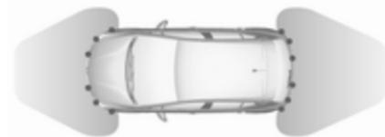
Die erweiterte Einparkhilfe ist immer mit der Front-Heck-Einparkhilfe kombiniert.
