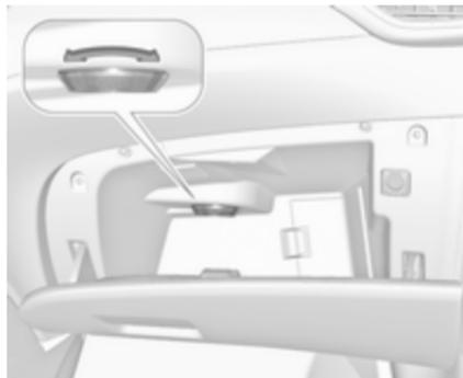
Die Belüftungsdüse lässt sich durch Drehen öffnen und schließen.
