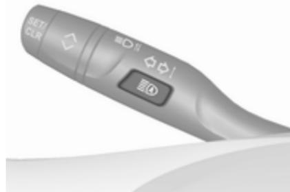
Die Funktion durch Drücken der Taste am Hebel aktivieren. Wenn der Fernlichtassistent aktiviert ist, leuchtet die LED in der Taste. Bei Geschwindigkeiten über 25 km/h wird das Fernlicht automatisch eingeschaltet.
