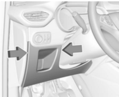
Bei Linkslenkern befindet sich der Sicherungskasten hinter einer Abdeckung in der Instrumententafel. Abdeckung an der Seite lösen und abnehmen.
