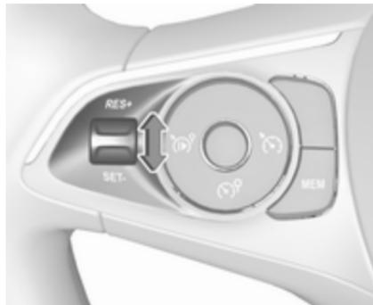
Auf die gewünschte Geschwindigkeit beschleunigen und das Daumenrädchen kurz auf **SET/-** schieben. Die aktuelle Geschwindigkeit wird als Höchstgeschwindigkeit gespeichert.
