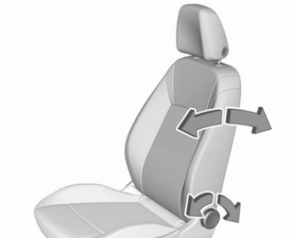
Handrad drehen. Zum Einstellen Rückenlehne entlasten.
