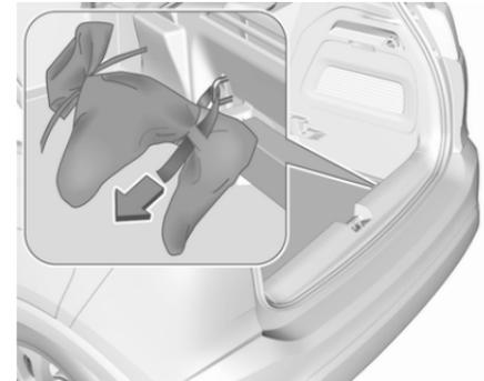
Den Gurt durch die hintere rechte Verzurröse ziehen, zweimal um den Beutel wickeln und festziehen, um den Beutel zu sichern.
