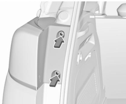
1. Die beiden Befestigungsschrauben der Leuchteneinheit herausdrehen.
