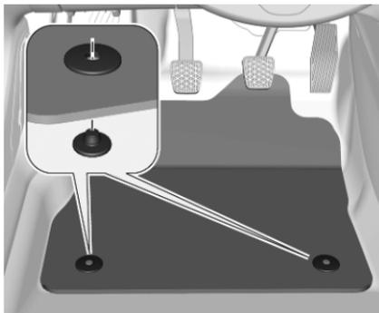
2. Schlitz in der Matte wie gezeigt an den Haltern ausrichten.
