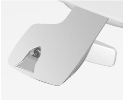
Windschutzscheibenaufkleber wie etwa Autobahnvignetten o.ä. nicht im Bereich des Innenspiegels anbringen. Sensor frei von Staub, Schmutz und Eis halten. Andernfalls könnten die Abtastzone des Regen-/Lichtsensors und der Sichtbereich der Kamera im Spiegelgehäuse beeinträchtigt werden.
