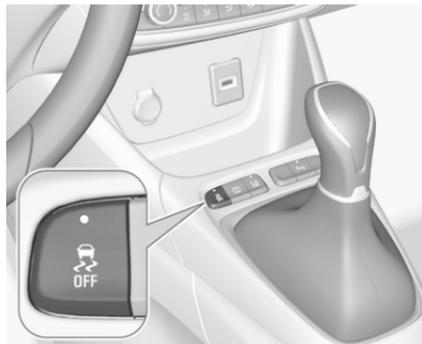
ESC und Traktionskontrolle können im Bedarfsfall durch Drücken auf
