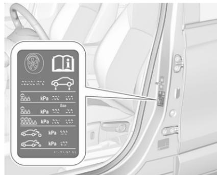
Das Reifendruckhinweisschild am linken vorderen Türrahmen gibt die Originalreifen und die entsprechenden Reifendrucke an.
