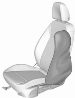
Der aufgeblähte Airbag dämpft den Aufprall, wodurch die Verletzungsgefahr für Oberkörper und Becken bei einem Seitenaufprall deutlich verringert wird.
