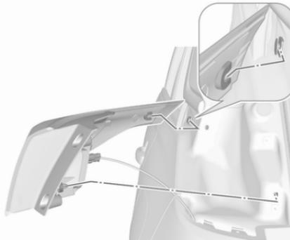
2. Die Leuchteinheit in die Karosserie einsetzen und mit den beiden Schrauben sichern.
