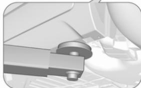
Hintere Arme der Hebebühne mittig unter den entsprechenden Wagenheberaufnahmen positionieren.
