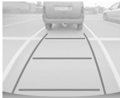
Auf dem Bildschirm wird der Bereich hinter dem Fahrzeug angezeigt. Die senkrechten Linien zeigen die Fahrzeugbreite bei ausgeklappten Seitenspiegeln an. Die Richtung der Linien ändert sich mit dem Lenkwinkel.
