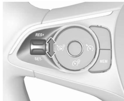
Bis zur gewünschten Geschwindigkeit beschleunigen und das Daumenrädchen auf **SET/-** drehen. Die aktuelle Geschwindigkeit wird als Höchstgeschwindigkeit gespeichert.
