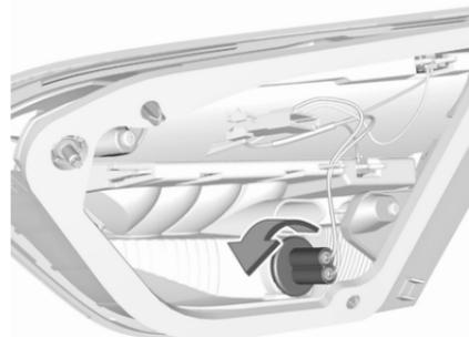
Lampenfassung des Rückfahrlichts nach links aus der Leuchteinheit herausdrehen.
