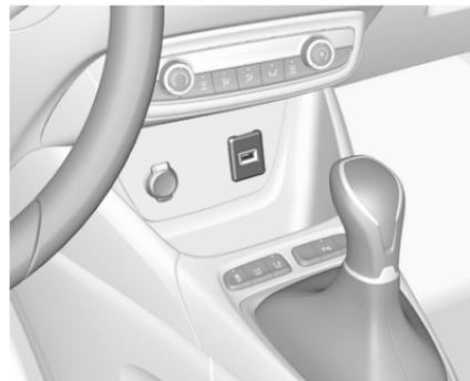
An einem oder zwei USB-Anschlüssen können Geräte geladen werden.
