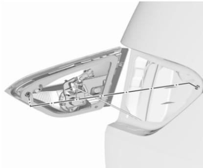
2. Die Leuchteneinheit an der Heckklappe befestigen.
