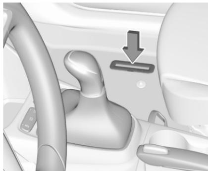
Die Fahrzeug-Identifizierungsnummer ist auf dem Typschild und im Bodenblech, unter der Bodenmatte sichtbar unter einer Abdeckung eingestanzt.
