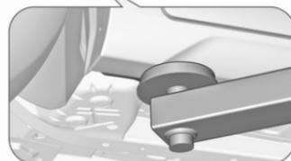
Vordere Arme der Hebebühne mittig unter den entsprechenden Wagenheberaufnahmen positionieren.
