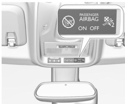
Wenn die Kontrollleuchte
