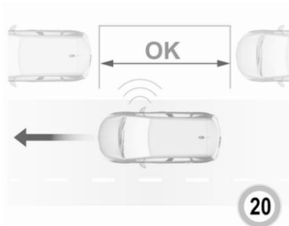
Wird eine freie Parklücke erkannt, wird im Colour-Info-Display eine visuelle Rückmeldung angezeigt und es ertönt ein erster Signalton. Langsam vorwärts fahren. Beim zweiten Signalton Fahrzeug anhalten, Rückwärtsgang einlegen, Lenkrad loslassen und mit maximal 7 km/h fahren.
