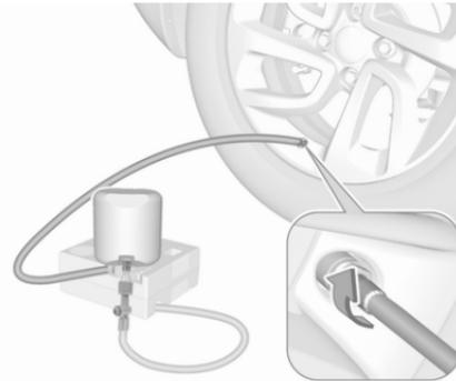
7. Den Einfüllschlauch am Reifenventil anschrauben.
