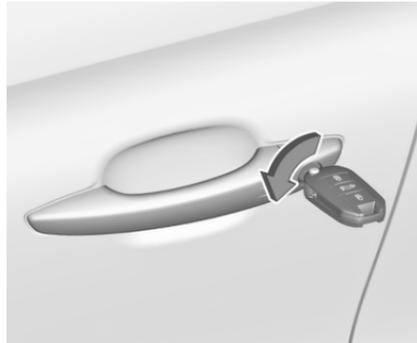
Die Fahrertür durch Einsetzen und Drehen des Schlüssels im Schließzylinder von Hand entriegeln. Bei funktionsfähiger Zentralverriegelung wird das Fahrzeug entriegelt.
