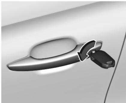
Schlüssel im Schließzylinder der Fahrertür drehen.
