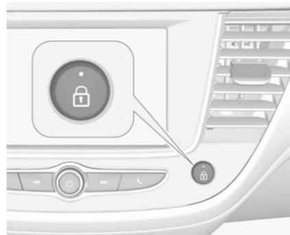
Bei eingeschalteter Zündung auf
