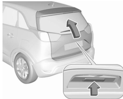
Heckklappentaste drücken und Heckklappe öffnen.
