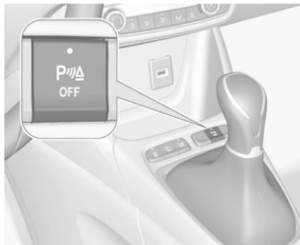
Das System wird automatisch bei einer Geschwindigkeit über 10 km/h oder nach mehr als 3 Sekunden langem Anhalten in einem Vorwärtsgang ausgeschaltet, oder wenn keine weiteren Hindernisse erkannt werden.
