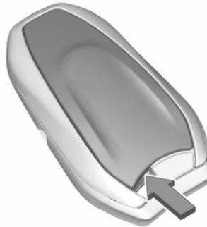
1. Zum Lösen die Abdeckung an der Öffnung mit einem kleinen Schraubendreher loshebeln.
