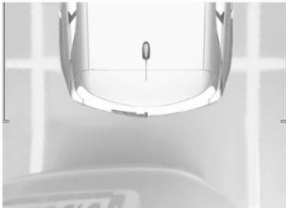
Die Kamera erfasst während des Manövers die Fahrzeugumgebung, um eine Draufsicht des Fahrzeughecks und dessen Umgebung zu
