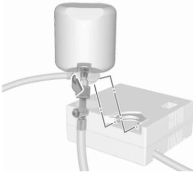
4. Den Kompressorluftschlauch an den Anschluss an der Dichtmittelflasche schrauben.
