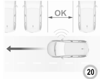
Wird eine freie Parklücke erkannt, wird im Colour-Info-Display eine visuelle Rückmeldung angezeigt und es ertönt ein Signalton. Anhalten, Rückwärtsgang einlegen, Lenkrad loslassen und mit maximal 7 km/h fahren.
