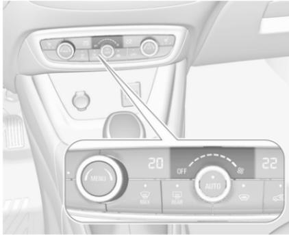
Luftstrom durch Drehen des Drehknopfs
