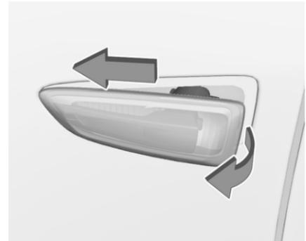
1. Die Leuchteneinheit nach vorn schieben und an der Rückseite abziehen.
