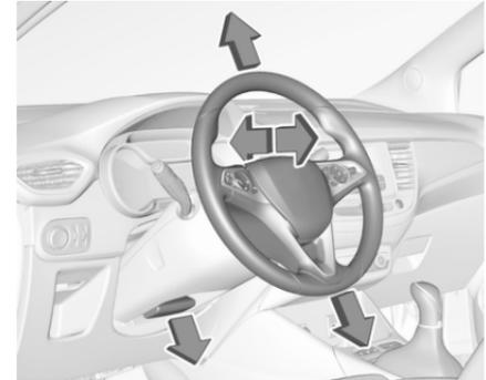
Griff entriegeln, Lenkrad einstellen, Griff einrasten und darauf achten, dass er komplett verriegelt ist. Lenkrad nur bei stehendem Fahrzeug und gelöster Lenkradsperrung einstellen.
