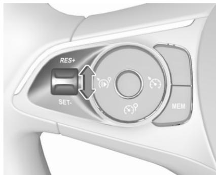
Bis zur gewünschten Geschwindigkeit beschleunigen und das Daumenrädchen auf **SET/-** drehen. Die aktuelle Geschwindigkeit wird gespeichert und beibehalten. Gaspedal kann gelöst werden.
