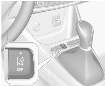
Die Spurverlassenswarnung wird durch Drücken auf
