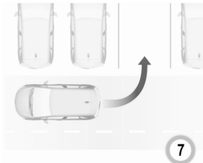
Vor- und zurücksetzen wie von der Einparkhilfe angewiesen und dabei auf die Warnungen der Einparkhilfe achten, bis das Ende des Manövers angezeigt wird. Bei abgeschlossenem Manöver erlischt  $P_8$  in der Instrumenteneinheit.
