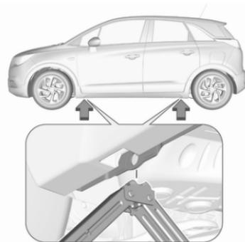
3. Sicherstellen, dass der Wagenheber richtig unter dem entsprechenden Aufnahmepunkt ausgerichtet ist.
