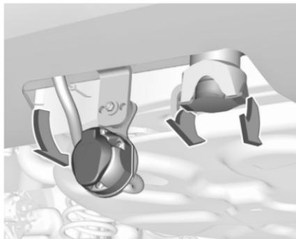
Anschlussbuchse nach unten drehen. Verschlussstopfen von der Öffnung der Kugelstange abziehen und verstauen.
