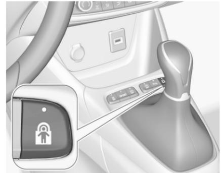
Fernbedientes System, das ein Öffnen der hinteren Türen mit den Innentürgreifen verhindert.
