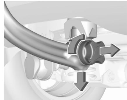
Die Schutzklappe öffnen und Schlüssel in Position
