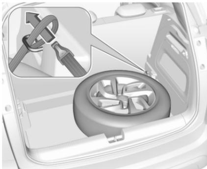
2. Das Schlaufenende des Gurts durch die vordere Verzuröse auf der entsprechenden Laderaumseite führen.
