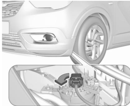
1. Die Lampenfassung nach links drehen und aus dem Reflektorgehäuse ziehen.
