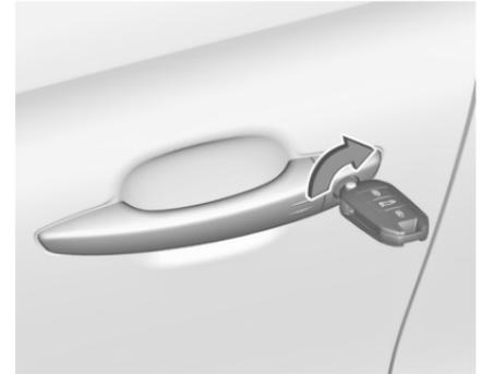
Die Fahrertür durch Einsetzen und Drehen des Schlüssels im Schließzylinder von Hand verriegeln. Bei funktionsfähiger Zentralverriegelung wird das Fahrzeug verriegelt.
