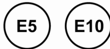
Kraftstoff gemäß der Norm EN228, mit Beimischung eines Biokraftstoffs gemäß der Norm EN15376.
