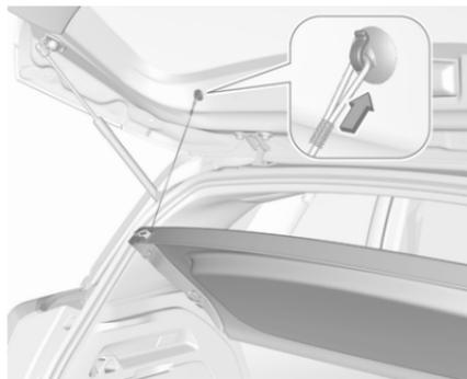
Haltebänder von Heckklappe lösen.
