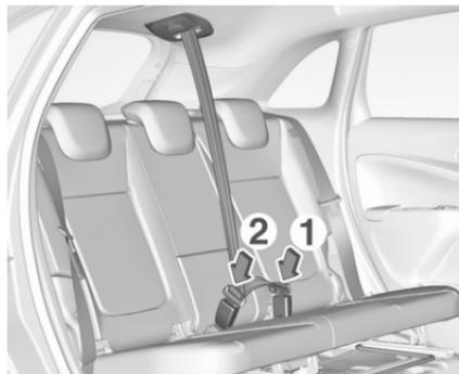
Untere Schließzunge in das linke Gurtschloss (1) am mittleren Sitz einstecken. Obere Schließzunge mit dem Sicherheitsgurt über das Becken und die Schulter ziehen, ohne den Gurt zu verdrehen, und in das rechte Gurtschloss (2) am mittleren Sitz einführen.
