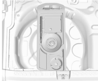
Der Schraubendreher und die Abschleppöse befinden sich in einer Kiste unter der Bodenabdeckung im Laderaum.
