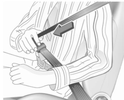
Den Sicherheitsgurt aus dem Aufroller herausziehen, unverdreht über den Körper führen und die Schloßzunge in das Gurtschloß einstecken, bis sie einrastet. Den Beckengurt während der Fahrt durch Ziehen am Schultergurt regelmäßig spannen.
