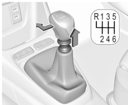
Zum Einlegen des Rückwärtsgangs beim 6-Gang-Getriebe den Ring nach oben ziehen.
