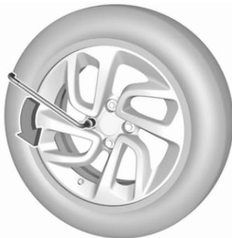
2. Radschraubenschlüssel herausklappen und sicherstellen, dass er gut sitzt. Jede Radmutter um eine halbe Drehung lockern.
