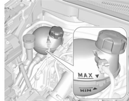
Bei kaltem Kühlsystem muss der Kühlmittelspiegel über der Markierung **MIN** liegen. Bei zu niedrigem Füllstand auffüllen.
