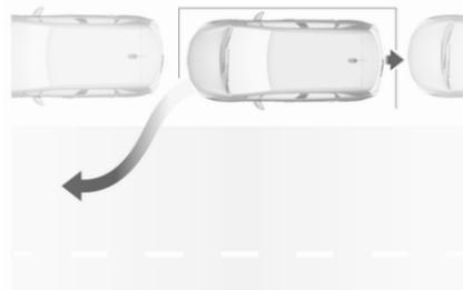
Vor- und zurücksetzen und dabei die Warnungen der Einparkhilfe beachten, bis das Ende des Manövers angezeigt wird. Das Manöver ist abgeschlossen, wenn sich die Vorderräder außerhalb der Parklücke befinden und  $P_8$  in der Instrumenteneinheit erlischt.
