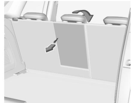
Die Armlehne kann auch vom Laderaum aus umgeklappt werden. Hierfür an der Schlaufe ziehen und auf die hintere mittlere Rückenlehne drücken.
