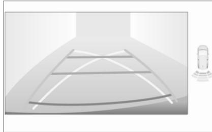
Die senkrechten Linien zeigen die Fahrzeugbreite ohne Spiegel und die allgemeine Ausrichtung des Fahrzeugs. Die waagerechten Linien zeigen den Abstand etwa 30 cm, 1 m und 2 m hinter dem Heckstoßfänger. Die sich überschneidenden Kurven zeigen den maximalen Wendekreis.
