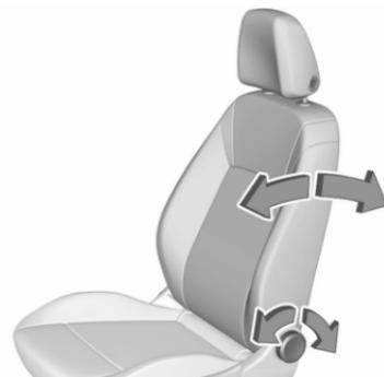
Handrad drehen. Zum Einstellen Rückenlehne entlasten.
