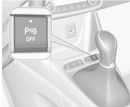
Beim Ausrücken des Rückwärtsgangs wird das System ausgeschaltet. Auf
