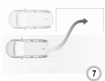
Vor- und zurücksetzen und dabei die Warnungen der Einparkhilfe beachten, bis das Ende des Manövers angezeigt wird. Bei abgeschlossenem Manöver erlischt  $P_8$  in der Instrumenteneinheit.
