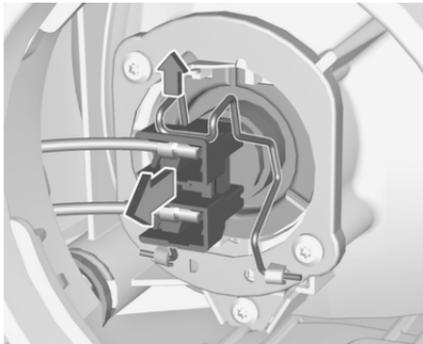
2. Halterung anheben und Anschlussstecker nach hinten ziehen.
