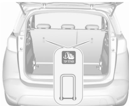
Zusätzlich zu den ISOFIX-Befestigungen, den Top-Tether-Befestigungsgurt an den Top-Tether-Befestigungsösen verankern.
