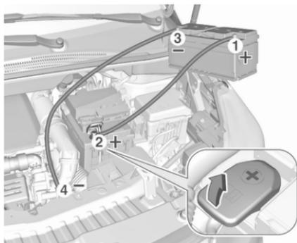
Die Pluspol-Schutzkappen an beiden Fahrzeugbatterien öffnen.
