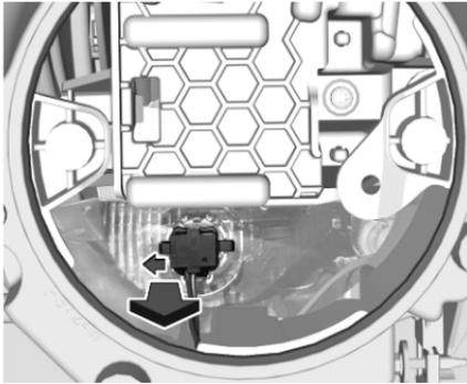
2. Die Lampenfassung nach links drücken und aus dem Reflektorgehäuse ziehen.
