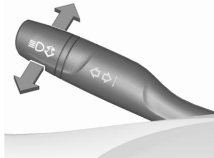
Durch Drücken wird von Ablend- auf Fernlicht umgeschaltet.
