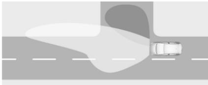
Beim Abbiegen werden je nach Lenkwinkel und Blinklicht spezielle LEDs eingeschaltet, um die Fahrtrichtung auszuleuchten. Er wird bei Geschwindigkeiten von bis zu 40 km/h aktiviert.
