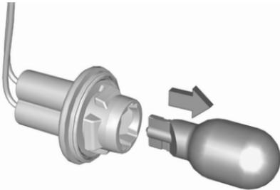
Gerade aus der Fassung herausziehen und ersetzen.
