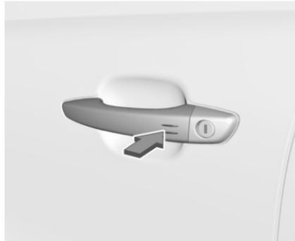
Elektronisches Schlüsselsystem: Beim Entriegeln des Fahrzeugs durch Drücken auf die Markierung an einem der Vordertürgriffe wird die Diebstahlwarnanlage deaktiviert.
