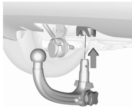
Die gespannte Kugelstange in die Öffnung einsetzen und kräftig nach oben drücken, bis sie hörbar einrastet.
