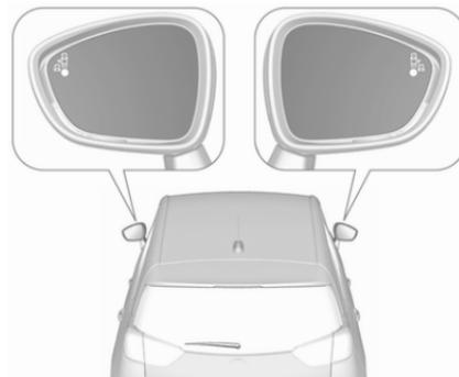
Erkennt das System bei Vorwärtsfahrt ein Fahrzeug im toten Winkel, leuchtet im entsprechenden Seitenspiegel eine LED auf.
