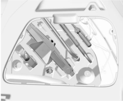
Wagenheber, Werkzeug, ein Sicherungsgurt für das beschädigte Rad und die Abschleppöse befinden sich im Werkzeugkasten an der rechten Laderaumwand.
