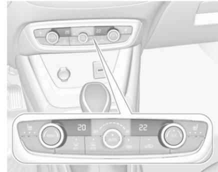
Temperaturvoreinstellungen für Fahrer und Beifahrer über den linken und rechten Drehregler festlegen. Der Regler auf der Beifahrerseite ändert die Temperatur für die Beifahrerseite. Der Regler auf der Fahrerseite ändert die Temperatur auf der Fahrerseite oder auf beiden Seiten, falls die Synchronisierung **MONO** im Menü der Klimatisierungseinstellungen aktiviert ist. Zum Öffnen des Menüs auf **MENU** drücken.
