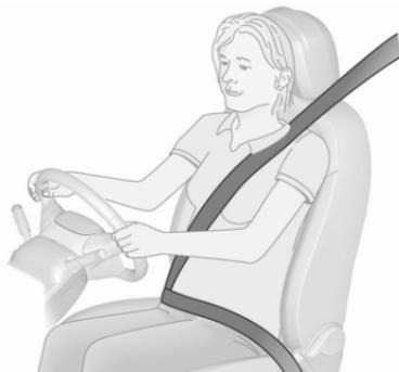
Bei starker Beschleunigung oder Verzögerung des Fahrzeugs blockieren die Sicherheitsgurte, um die Insassen in ihrer Sitzposition zu halten. Dies verringert die Verletzungsgefahr drastisch.
