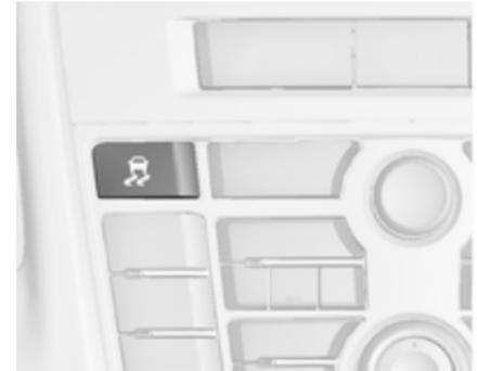
Für ein sportlicheres Fahrverhalten können die elektronische Stabilitätsregelung und die Traktionskontrolle separat deaktiviert werden:
