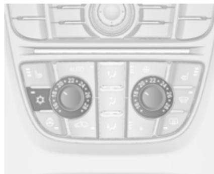
☼ drücken, um die Kühlung einzuschalten. Die LED in der Taste leuchtet auf, um die Aktivierung anzuzeigen. Die Kühlung ist nur bei laufendem Motor und eingeschaltetem Gebläse der Klimatisierung funktionsfähig.
