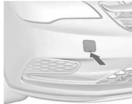
Die Spitze eines Schlitzschraubendrehers mit einem Tuch umwickeln, um den Lack zu schützen. Mit dem Schraubendreher in den Schlitz unten an der Abdeckung fahren. Abdeckung durch vorsichtiges Abwärtsbewegen des Schraubendrehers lösen.
