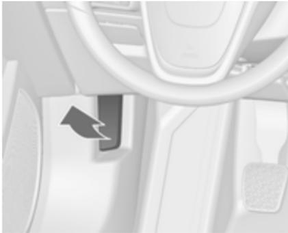
Entriegelungshebel ziehen und in die Ausgangsposition zurückführen.
