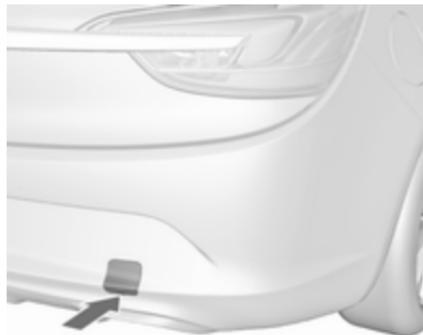
Die Spitze eines Schlitzschraubendrehers mit einem Tuch umwickeln, um den Lack zu schützen. Mit dem Schraubendreher in den Schlitz an der unteren Kante der Abdeckung fahren. Abdeckung durch vorsichtiges Abwärtsbewegen des Schraubendrehers lösen.
