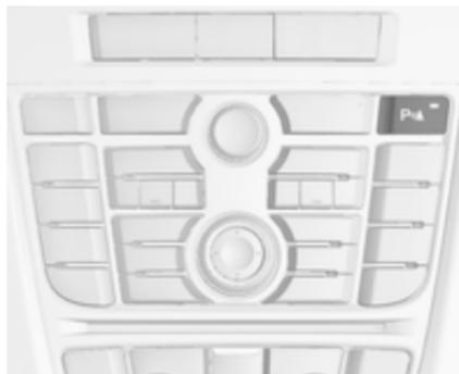
Das System kann durch kurzes Drücken der Einparkhilfe-Taste **P**▲ oder **P**▲▲ manuell deaktiviert werden.
