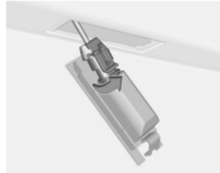
3. Die Lampenfassung linksherum drehen, um sie aus dem Lampengehäuse zu entfernen.
