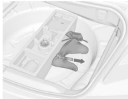
Die Tasche mit der Kupplungskugelstange befindet sich in der Nähe des Reifenreparatursets unter der Laderaumabdeckung.
