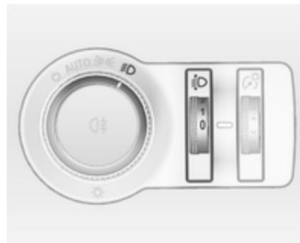
Zur Anpassung der Leuchtweite an die Fahrzeugbeladung, um Blendwirkung zu reduzieren: Daumenrädchen
