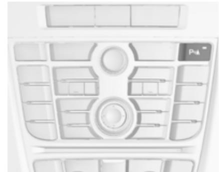
Nach Herausnehmen des Rückwärtsgangs wird das System automatisch ausgeschaltet.
