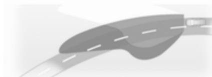
Der Lichtstrahl wird auf Basis des Lenkradwinkels und der Geschwindigkeit geschwenkt, was die Ausleuchtung von Kurven verbessert. Kontrollleuchte  $\text{⊞} \rightarrow 97$ .
