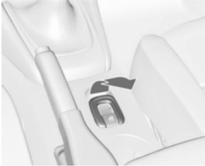
Schalter gezogen halten, bis das Verdeck vollständig geöffnet und die Verdeckabdeckung geschlossen ist. Bei diesem Vorgang werden alle Fenster geöffnet.
