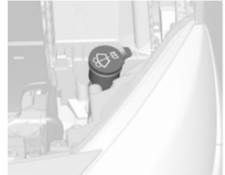
Mit einem Gemisch aus sauberem Wasser und einer geeigneten Menge zugelassener frostschutzmittelhaltiger Scheibenwaschflüssigkeit auffüllen.
