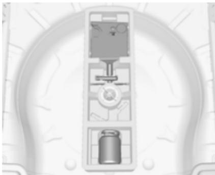
Das Reifenreparaturset befindet sich in einem Kasten unter der Abdeckung des Laderaumbodens.
