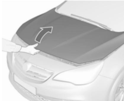
Den Sicherungshaken zur linken Fahrzeugseite drücken und die Motorhaube öffnen.
