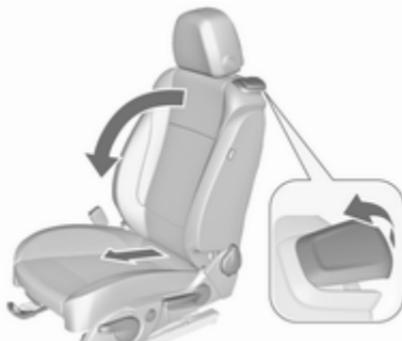
Entriegelungshebel anheben und Rückenlehne vorklappen, danach Sitz bis zum Anschlag nach vorne schieben.
