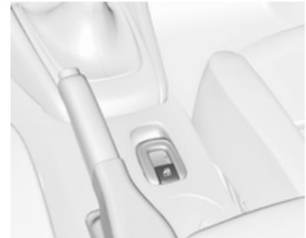
Der Schalter in der Mittelkonsole dient der Betätigung aller Fenster.
