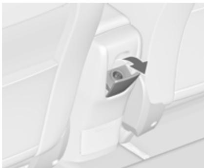
Eine weitere 12-Volt-Zubehörsteckdose befindet sich in der hinteren Konsole. Die Abdeckung nach unten klappen.
