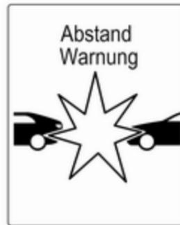
Wenn der Abstand zu einem vorausfahrenden Fahrzeug zu gering wird oder Sie sich einem anderen Fahrzeug zu schnell nähern, wird im Driver Information Center das Kollisionssymbol angezeigt.
