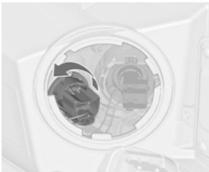
Die Abbildung zeigt die Ausführung mit adaptivem Fahrlicht. Lampenfassung gegen den Uhrzeigersinn drehen, um sie auszurasten und aus dem Reflektor zu entnehmen.
