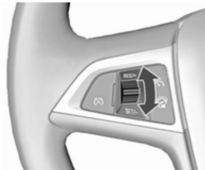
Bei aktiviertem Geschwindigkeitsbegrenzer das Daumenrädchen auf Position **RES/+** gedreht halten oder wiederholt auf Position **RES/+** drehen, bis die gewünschte Höchstgeschwindigkeit im Fahrerinformationszentrum angezeigt wird.
