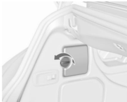
2. Abdeckung in Seitenverkleidung lösen und herausnehmen.
