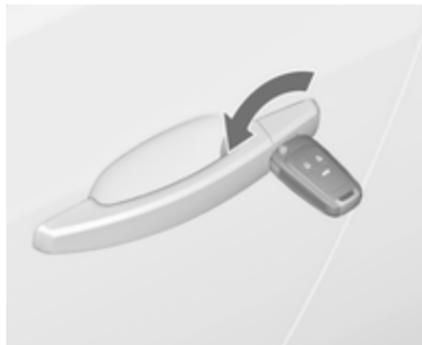
Die Fahrertür durch Drehen des Schlüssels im Schloss von Hand entriegeln. Zündung einschalten und Zentralverriegelungstaste
