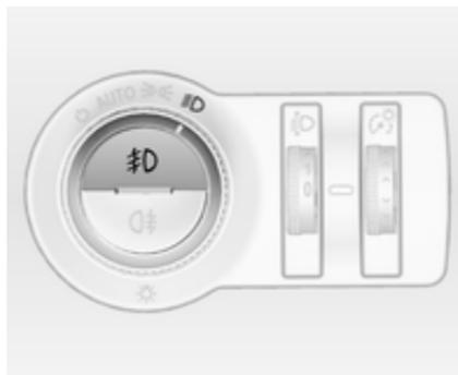
Wird durch Drücken von **D** bedient.
