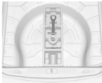
Wagenwerkzeug und die Abschleppöse sind in einem Werkzeugkasten untergebracht, der sich unter der Bodenabdeckung im Laderaum befindet.
