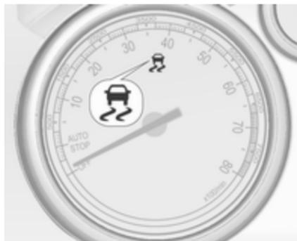
Die Traktionskontrolle ist nach jedem Motorstart funktionsfähig, sobald die Kontrollleuchte
