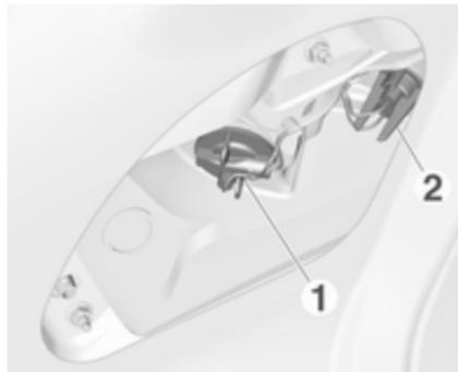
Die Glühlampenfassung links herum drehen, um sie zu entfernen.
