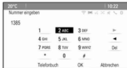
Die gewünschte Nummer eingeben. Auf dem Bildschirm **Del** auswählen oder an der Instrumententafel **BACK** drücken, um die zuletzt eingegebene Ziffer zu löschen.
