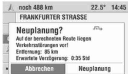
Bei der dynamischen Zielführung wird die gesamte aktuelle Verkehrssituation, die das Infotainment System über RDS-TMC empfängt, in die Berechnung der Route mit einbezogen. Im Fall einer Verkehrsbehinderung (z.B. Stau, Sperrung) auf der geplanten Route erhalten Sie vom Infotainment System einen Hinweis und kön-
