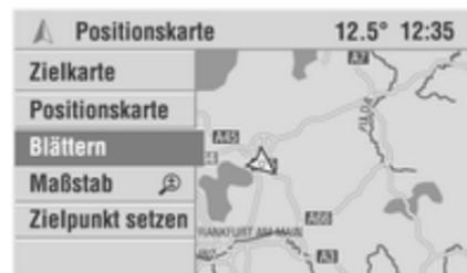
Wenn die Positionskarte oder Zielkarte angezeigt wird, kann der Cursor mithilfe der Kreuzwippe verschoben werden.
