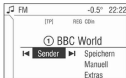
Die einzelnen Punkte eines Menüs lassen sich mithilfe eines Cursors, der durch Drehen des Multifunktionsknopfes bewegt wird, auswählen. Der Cursor hat die Form eines Rahmens (Balken). Er zeigt an, welcher Menüpunkt ausgewählt ist.
