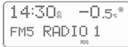
Wenn der momentan eingestellte Sender kein RDS-Sender ist, sucht das Radio automatisch nach dem nächsten empfangbaren RDS-Sender.
