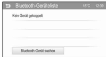
4. Auf dem Infotainment System: auf die Schaltfläche **Bluetooth-Gerät suchen** tippen. Alle sichtbaren Bluetooth-Geräte in der Umgebung werden in einer Liste angezeigt.
