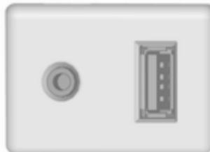
In der Mittelkonsole unterhalb der Bedienelemente für die Klimaanlage befinden sich ein AUX-Eingang und eine USB-Buchse für den Anschluss externer Audiodatenquellen.
