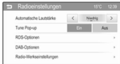
Zum Zurücksetzen aller Einstellungen auf **Radio-Werkseinstellungen** tippen und die daraufhin angezeigten Meldungen bestätigen.
